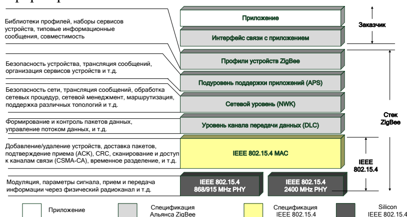
Рис. 5.4 - Конфигурация стеков протоколов 802.15.4 и ZigBee
