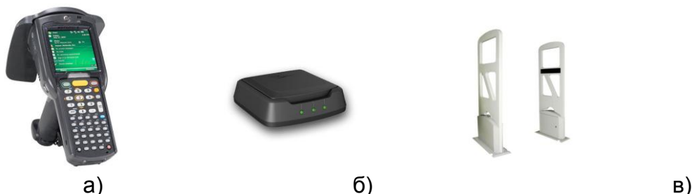
Рис. 2.7 – Считыватели (ридеры) RFID-меток (изображения не в масштабе): а) портативный (ручной); б) настольный (RFID-планшет); в) стационарный (RFID-ворота)
