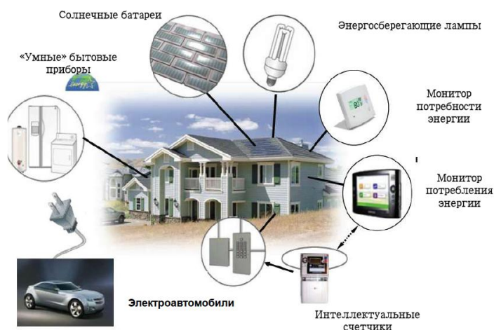
Рис. 6.3 – Основные компоненты «умного дома»
